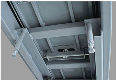
调平螺栓，能在安装完成后，二次调整举升机平台的水平度
