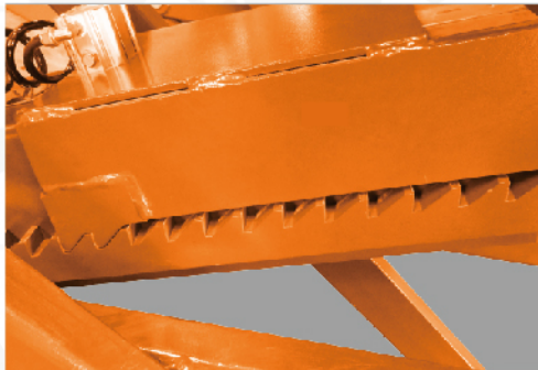
机械锁和气动解锁装置
