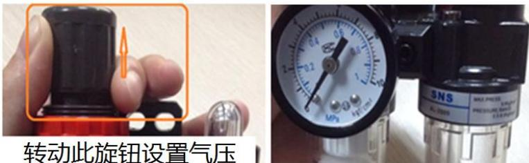
建议向油杯中加入透平 1 号油 (ISO VG32)。使用油杯顶部的旋钮调整滴油量。
