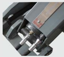
液压防爆阀，在油管爆裂，机械保险失效的情况下，防止车辆瞬间掉落。防爆阀工作的情况下，从最大高度下降的时间不少于20秒。
