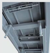
调平螺栓，能在安装完成后，二次调整举升机平台的水平度。
