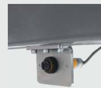
红外调平保护装置，防止车辆侧翻
