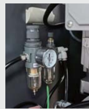
油水分离器，可除掉气源中的水分/油等杂质，可减少机器工作故障，延长机器的使用寿命。
