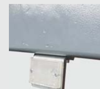
红外调平保护装置，防止车辆侧翻
