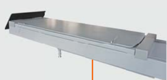
高精度侧滑板 配自动回中装置，能保证侧滑板迅速回位。左右能滑动50mm，能以中心为旋转中心旋转5度。
