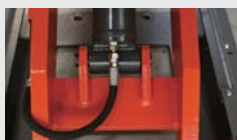
耐高压的双层钢丝网油管
