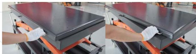
浮动式工作平台，可实现平面半径35mm范围内任意移动
