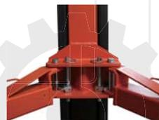
结实的滑台，沙钢钢材，举升臂离地自锁装置。
