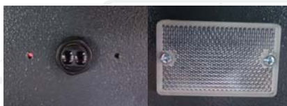
标配红外同步保护系统 防止平台不同步运行导致事故
