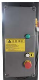
低压 (24V) 控制系统 (EE-C10)
