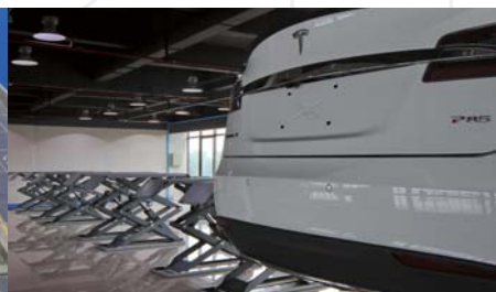
标配红外同步保护系统 防止平台不同步运行导致事故
